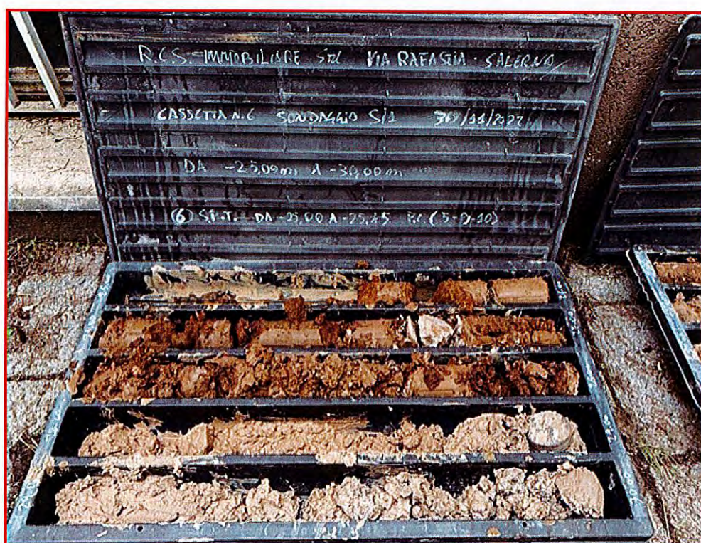
Fig. 6.9 Sondaggio S1 - Cassetta C6 - (da 25,00 a -30,00 mt.)
