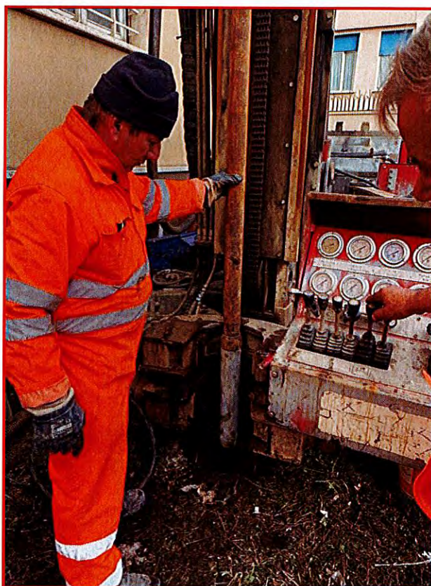
Fig. 6.13 Prelievo di campione indisturbato con fustella d'acciaio nel sondaggio S1
