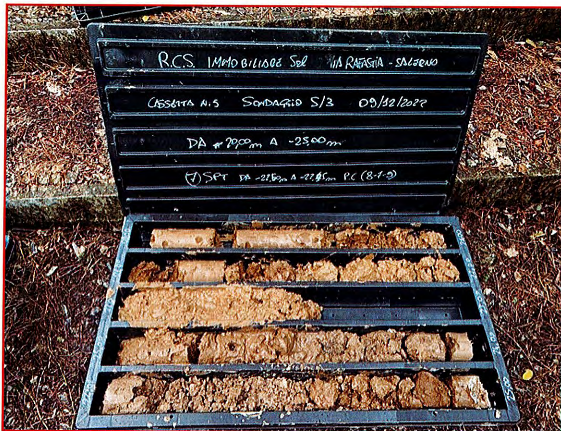
Fig. 6.35 Sondaggio S/3 - Cassetta C5 - (da -20,00 a -25,00 mt.)
