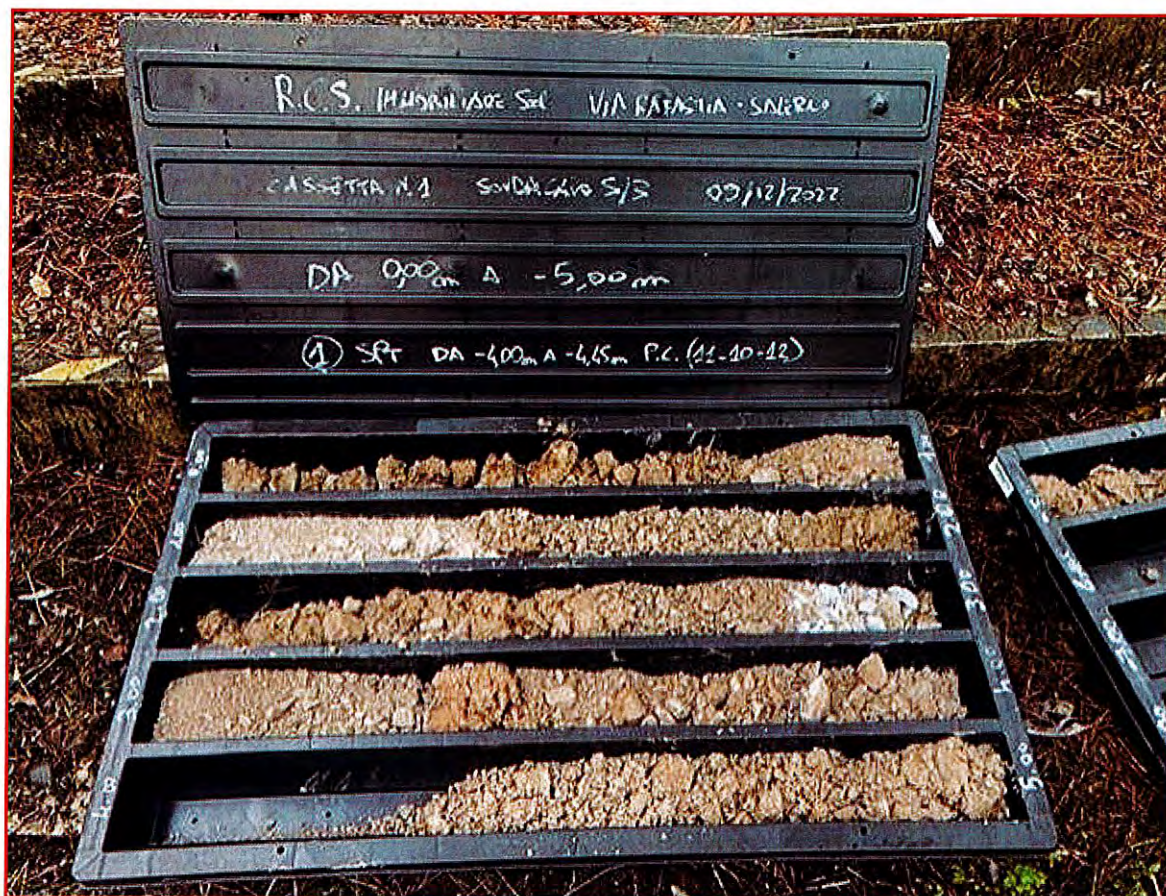
Fig. 6.31 Sondaggio S/3 - Cassetta C1 - (da 0,00 a -5,00 mt.)
