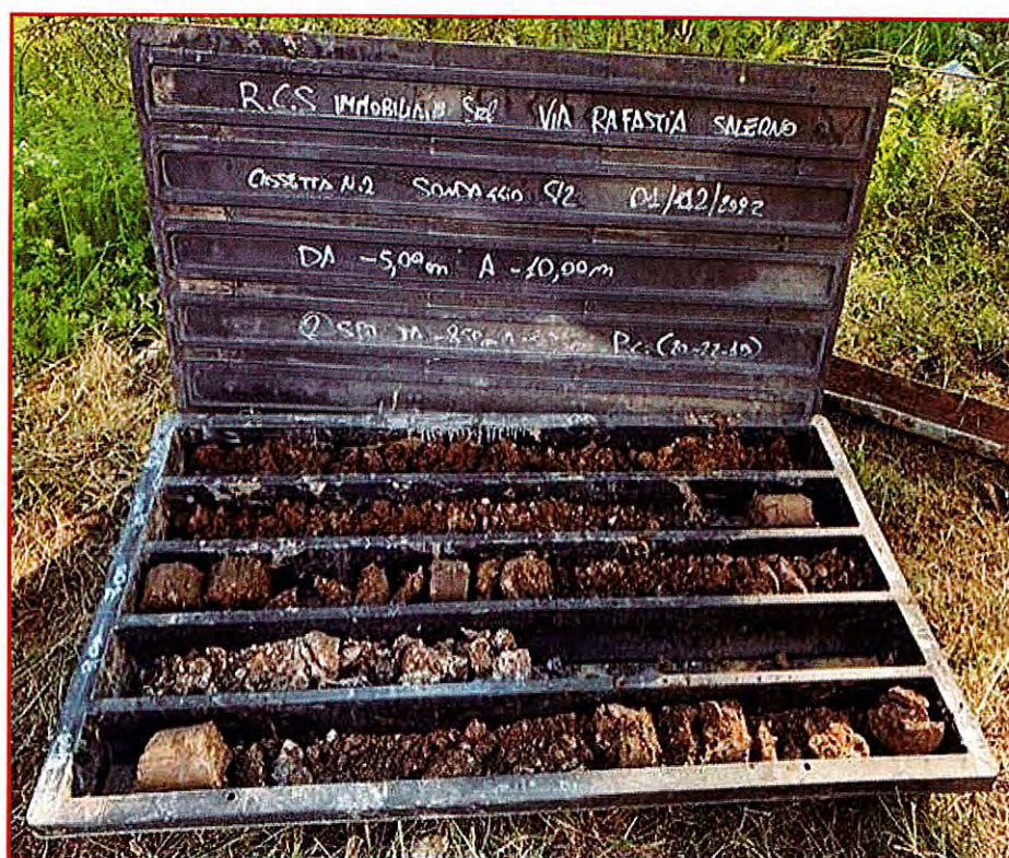
Fig. 6.19 Sondaggio S/2 - Cassetta C2 - (da -5,00 a -10,00 mt.)
