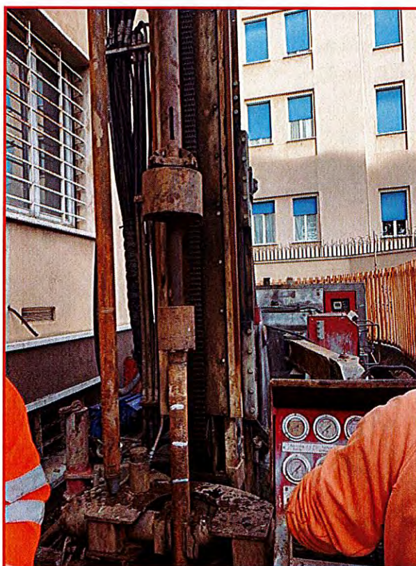
Fig. 6.3 Fase esecutiva prova penetrometrica dinamica del tipo "SPT" (Standard penetration test)
