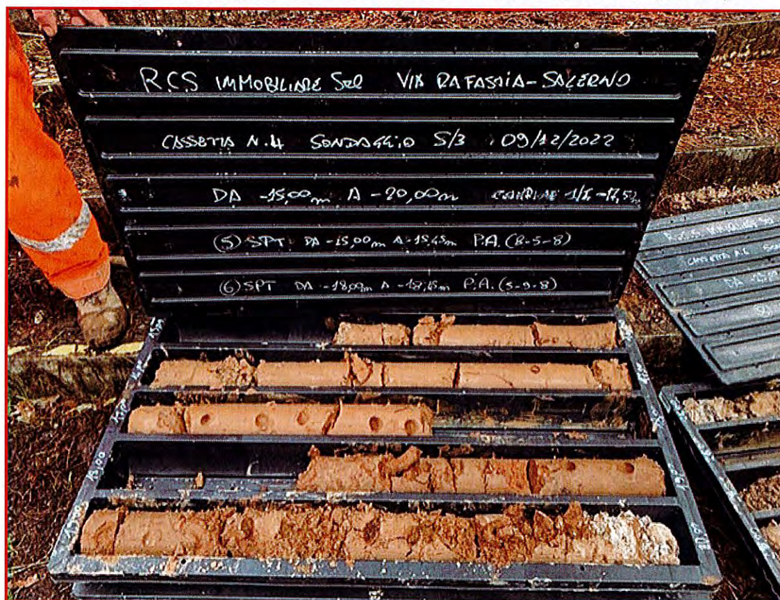
Fig. 6.34 Sondaggio S/3 - Cassetta C4 - (da -15,00 a -20,00 mt.)
