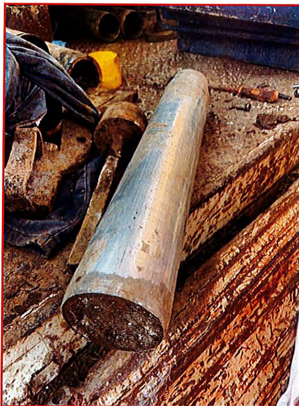
Fig. 6.26 Prelievo di campione indisturbato con fustella d'acciaio nel sondaggio S2
