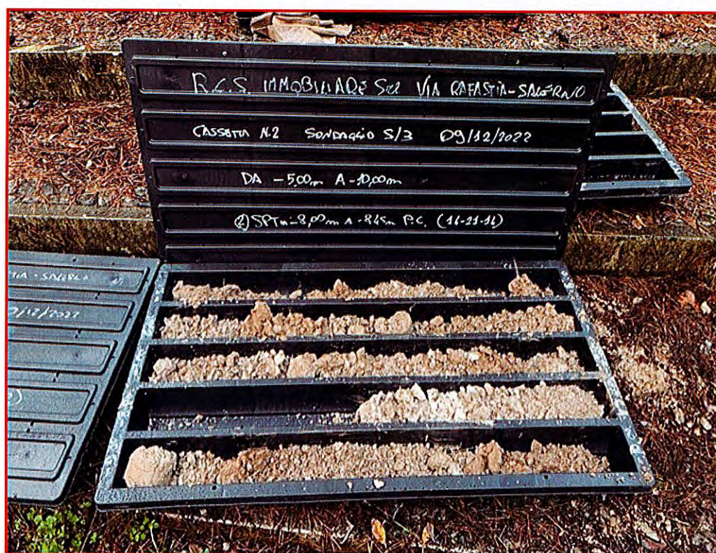
Fig. 6.32 Sondaggio S/3 - Cassetta C2 - (da -5,00 a -10,00 mt.)
