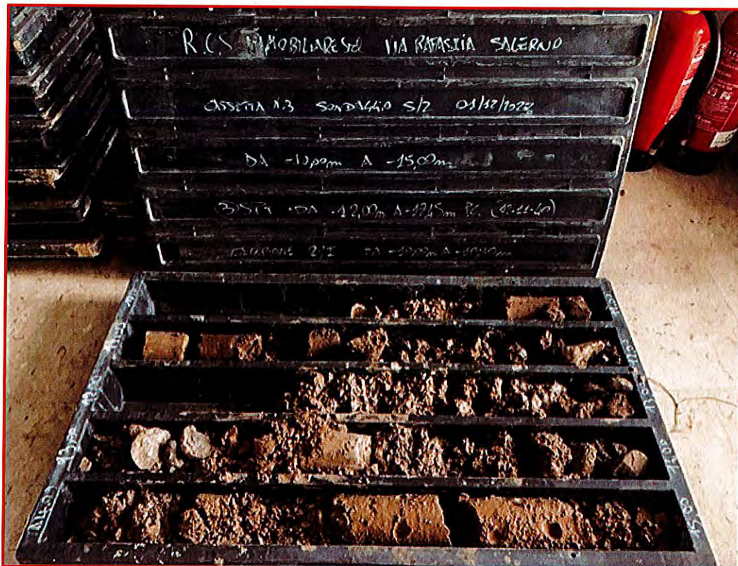
Fig. 6.20 Sondaggio S/2 - Cassetta C3 - (da -10,00 a -15,00 mt.)
