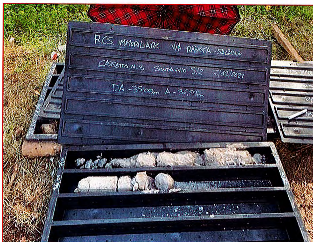
Fig. 6.25 Sondaggio S/2 - Cassetta C8 - (da -35,00 a -36,50 mt.)
