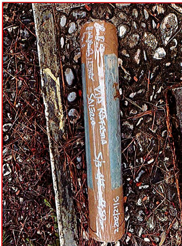
Fig. 6.41 Prelievo di campione indisturbato con fustella d'acciaio nel sondaggio S3
