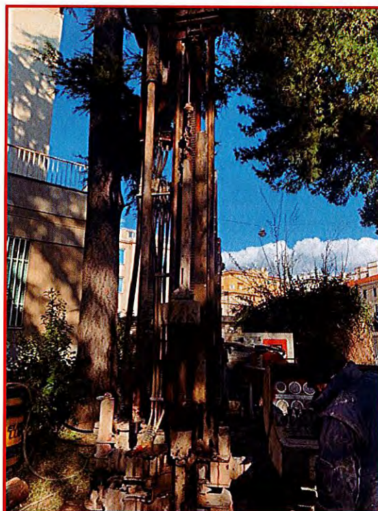
Fig. 6.17 Fase esecutiva prova penetrometrica dinamica del tipo "SPT" (Standard penetration test)
