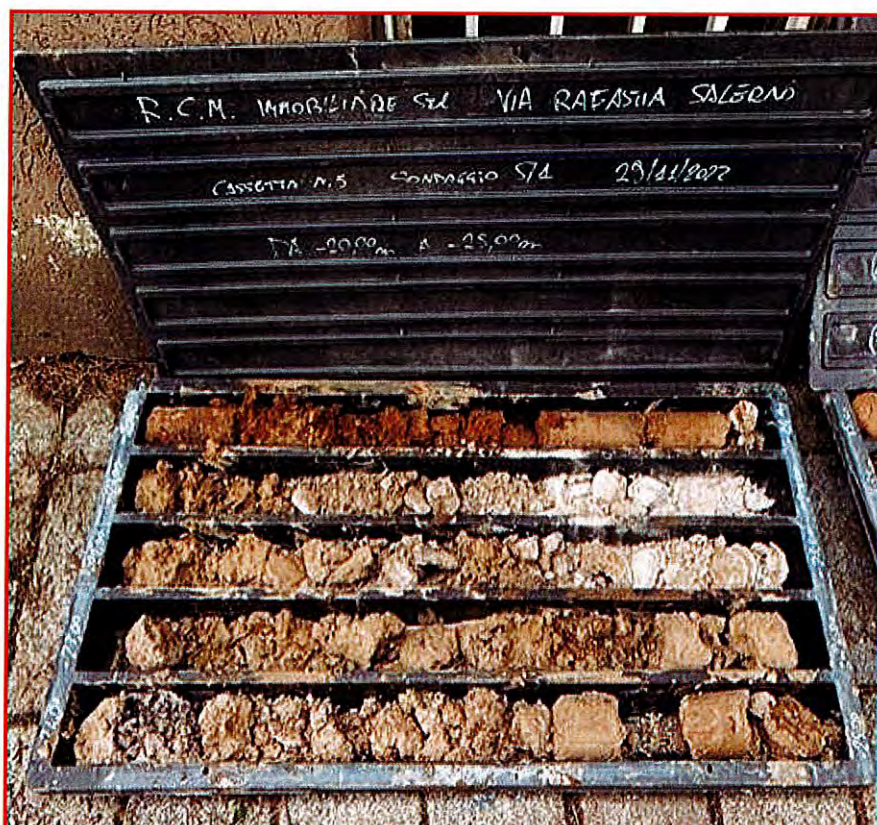
Fig. 6.8 Sondaggio S1 - Cassetta C5 - (da 20,00 a -25,00 mt.)
