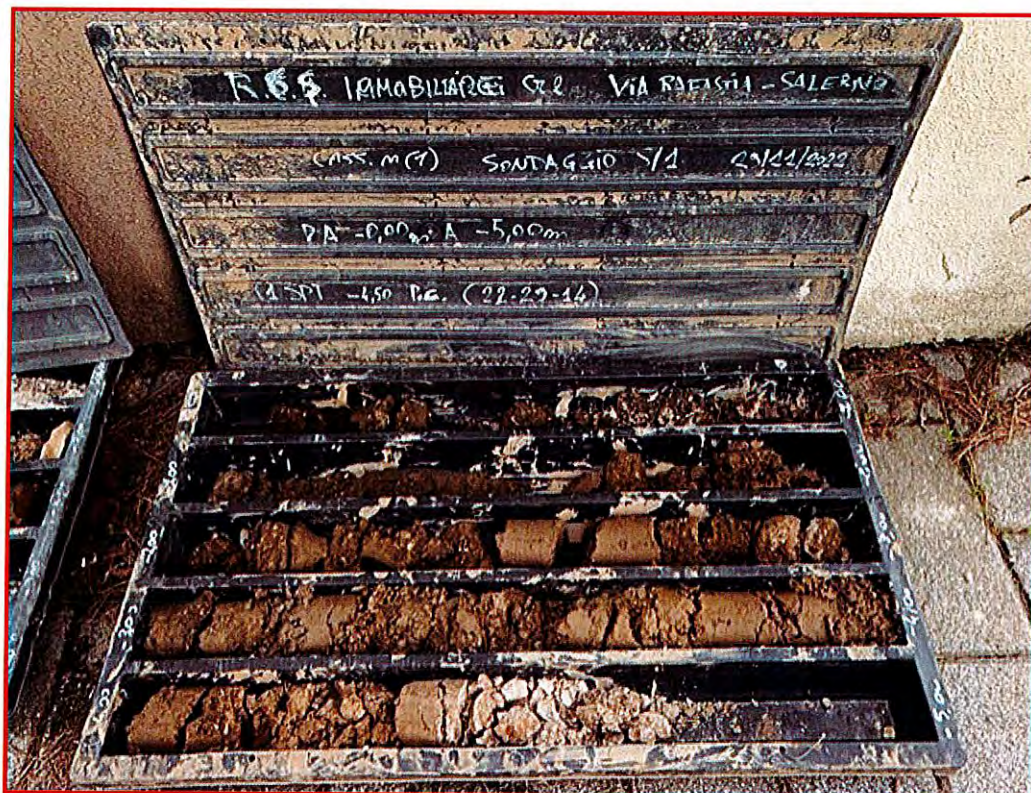
Fig. 6.4 Sondaggio S1 - Cassetta C1 - (da 0,00 a -5,00 mt.)
