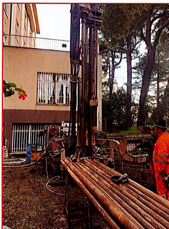
Fig. 6.30 Fase esecutiva prova penetrometrica dinamica del tipo "SPT" (Standard penetration test)
