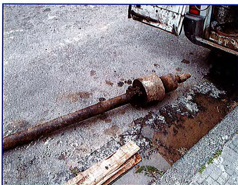
Fig 7.3 Maglio battente per prova SPT
