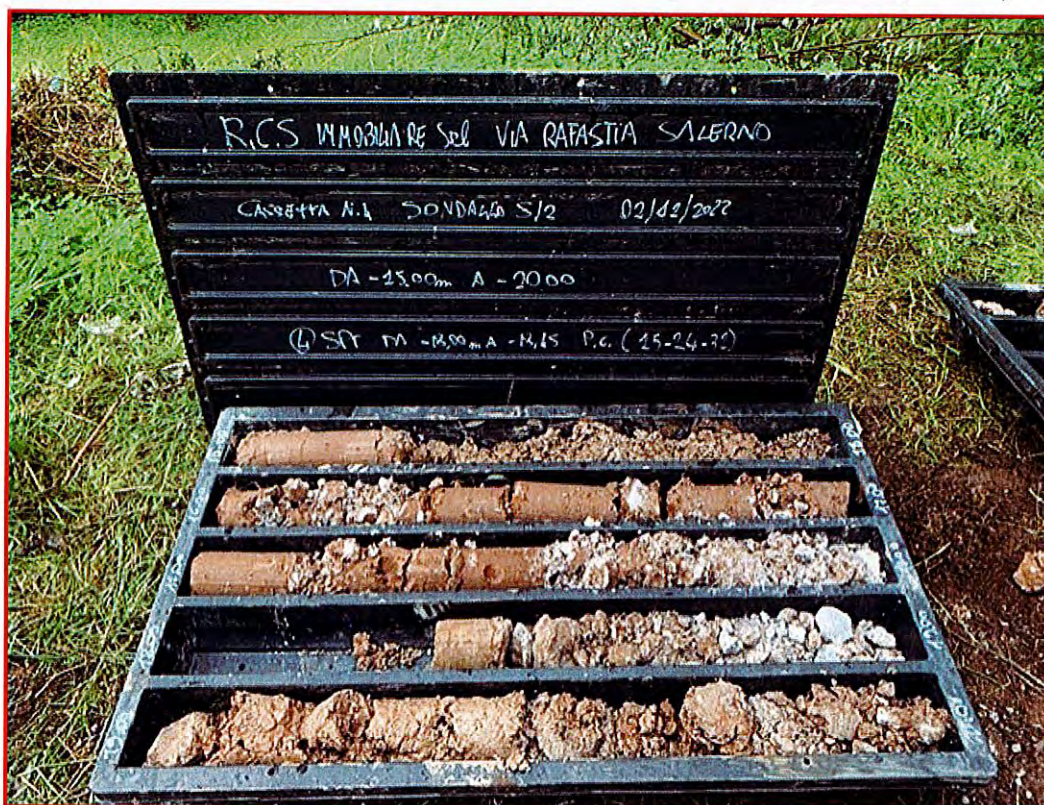
Fig. 6.21 Sondaggio S/2 - Cassetta C4 - (da -15,00 a -20,00 mt.)
